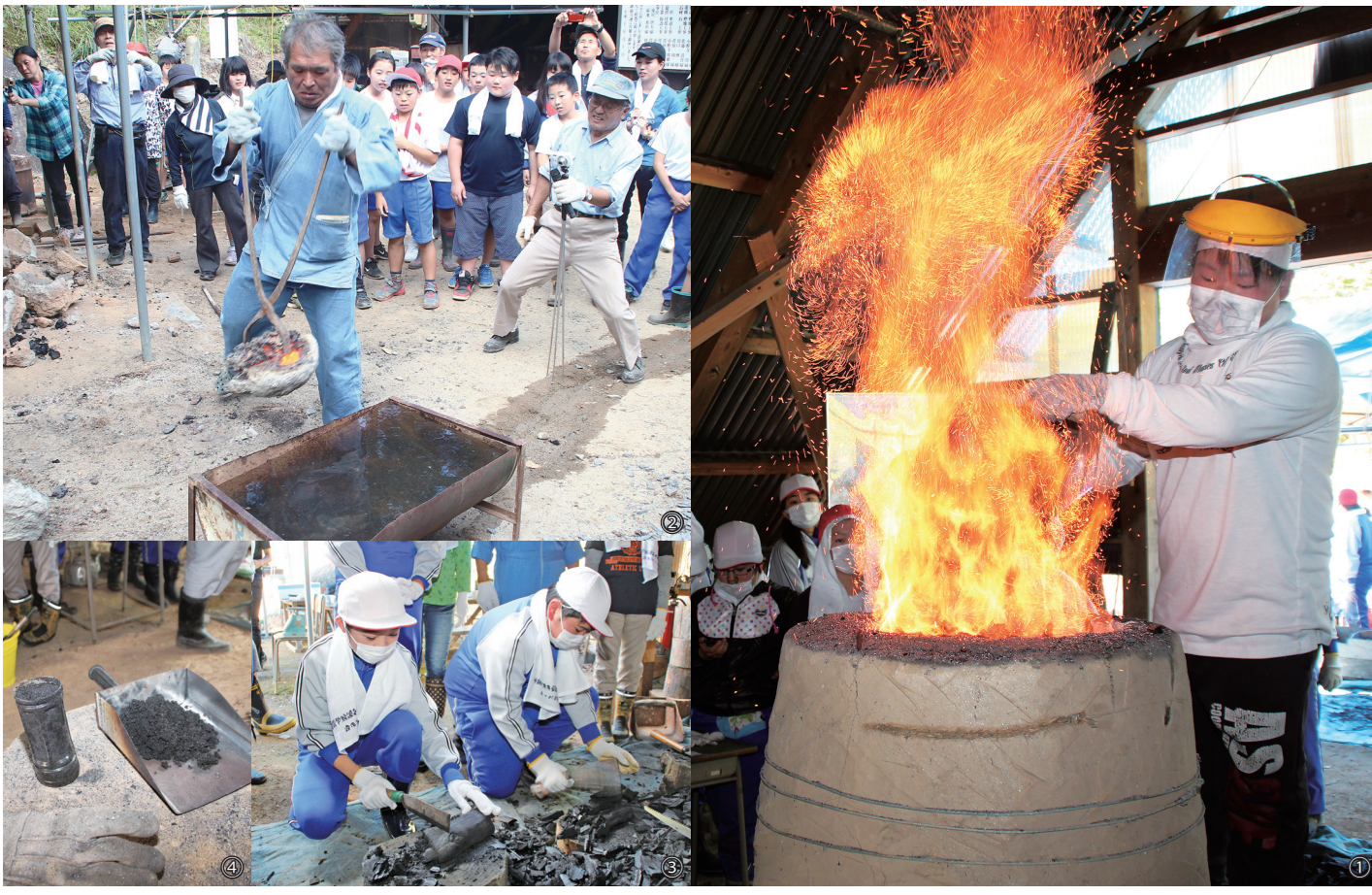
① 炉に木炭を投入すると炎が噴き出す ② 炉から取り出した熱い鉄の塊を水で冷却 ③ 地元産の木炭を燃えやすいように粉碎 ④ 児童が採取した原料の砂鉄
