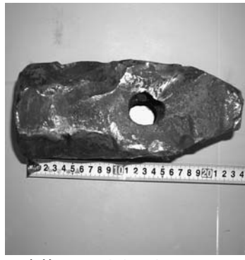
事故の原因となったハンマー
