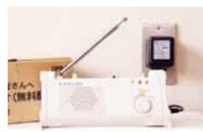
専用ラジオ前面のダイヤルを右に回すと放送が聞こえます。普段は、ちょうどいい音量で聞いてください。この状態で起動信号を受信すると、音量が最大になります。解除信号を受信すると、音量は元に戻ります。ダイヤルを左にカチッと音がするまで回すと音声は聞こえません。普段、ラジオを聞いていないときはこの状態です。この状態で起動信号を受信すると、専用ラジオの電源が自動で入ります。
