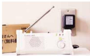
市が事業所を含む全ての世帯に配布した「FMあすも専用ラジオ」は、緊急情報を伝えるための信号を受信すると電源が入っていない状態でも自動で放送が流れる機能を備えています。
