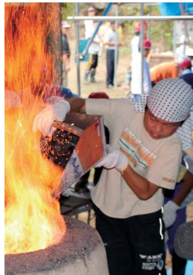
炎が燃えさかる溶鉱炉に砂鉄と木炭を投入する児童
