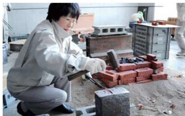
火床で熱した五寸釘からペーパーナイフを手作り
