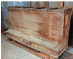
吹子(輪)とは、金属の加工や精錬で高温が必要となる場合に、燃料の燃焼を促進するために空気を送り出す道具です。現存する3基の吹子のうち、2基は長さ172センチと大型のもので、残り1基は長さ118センチとやや小型で、いずれも「陸前気仙御吹次師高田大町」(現陸前高田市高田町大町)「菅笠七作」の焼き印があります。
