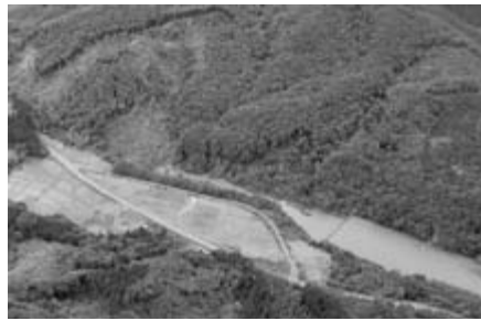
▲ 大量の土砂が磐井川をせき止めた市野々原地内。右は上流の市野々原砂防ダム(6月14日) ◀ 同土砂ダムでは18日から24時間体制で仮排水路の開削工事が行われ、21日から排水開始。引き続き水路の断面拡大の工事が行われました(6月27日)
