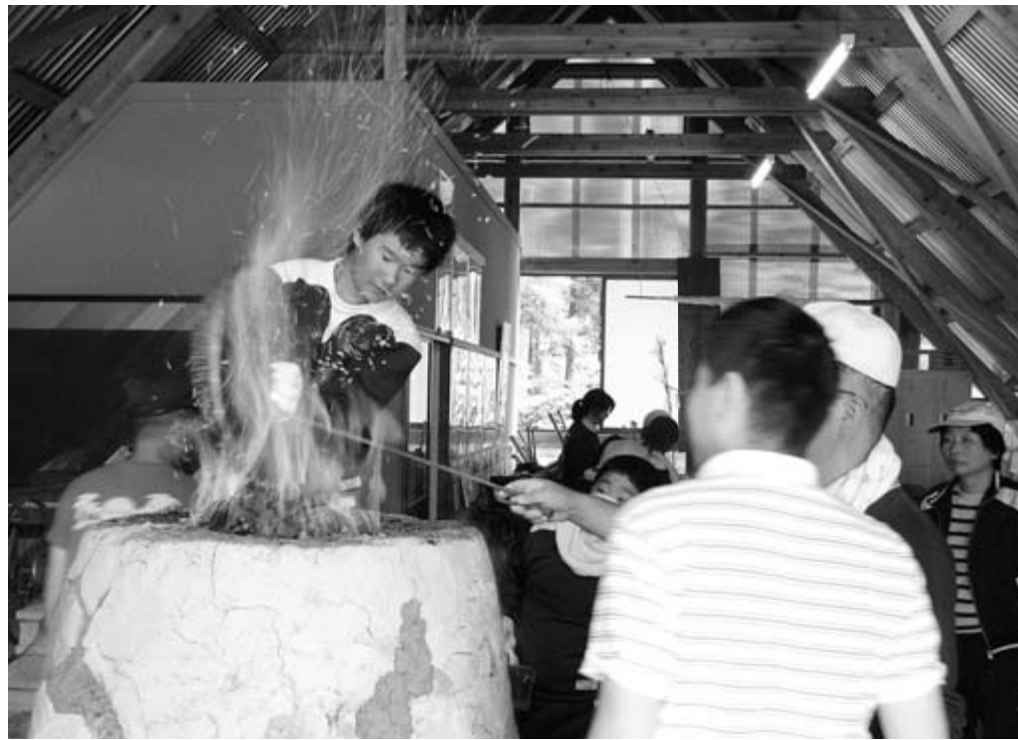
燃えさかる炉に砕いた木炭と砂鉄を投入すると炎が吹き上がります
